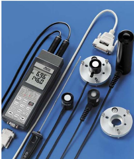
El foto/radiómetro y termómetro datalogger **DO 9721** ha sido estudiado para medir la iluminancia, irradiancia, luminancia y temperatura.
